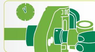
4. Mantén el Tubo y la Conexión en los dados del termofusor el tiempo de calentamiento acorde al diámetro. (Ver tabla 3 página 29)
