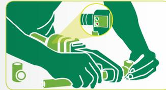
3. Verifica que la temperatura del termofusor sea adecuada (LED verde) e inserta el Tubo y Conexión hasta la profundidad de inserción sin girarlos.
