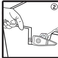
Desatornille la tuerca que asegura la manivela al tanque sanitario y retírela. Introduzca la nueva manivela y apriete la tuerca manualmente. En caso de ser necesario utilizar una llave inglesa ajustable. Apretar en exceso puede dañar el producto.
