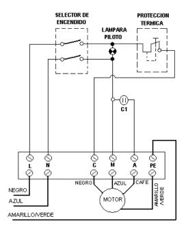
CONEXIONES AL TABLERO DE CONTROL MONOFASICO
